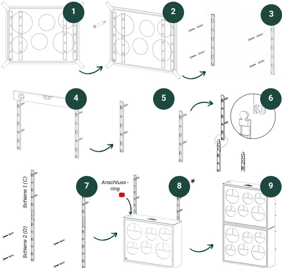
\*Immer den Anschlussring in die Gießöffnung der unteren Box einlegen.
